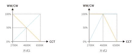
我司色温控制器标准品采用方式1,即中间色温时WW和CW各50%亮度,此时色温控制器不能同时输出100%亮度。 方式2时,中间色温为WW和CW各100%亮度,需定制软件。
